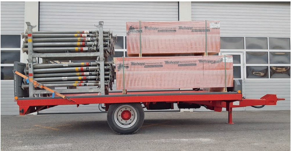
Material-Anhänger kippar mit Rampen (6 to. Nutzlast).
